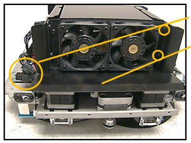
Disconnect 2 fan wires
